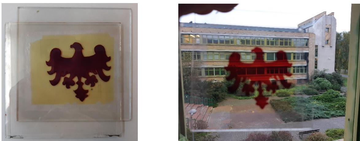
Rys. 1. Demonstracyjne fotoogniwo z pojedynczym barwnikiem MK2 o rozmiarach 10 x 10 cm wykonane w naszej grupie badawczej. Po lewej: aktywny barwnik pokrywa powierzchnię orzelka z logo UAM, reszta jest wypełniona elektrolitem. Po prawej: fotoogniwo na tle budynku Wydziału Fizyki UAM.
