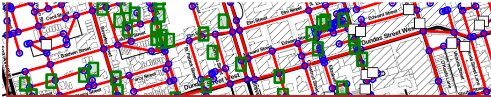
Rysunek 1: Przykładowy model symulacji wieloagentowej przestrzeni miejskiej. Samochody oznaczono prostokątami a skrzyżowania okręgami.
