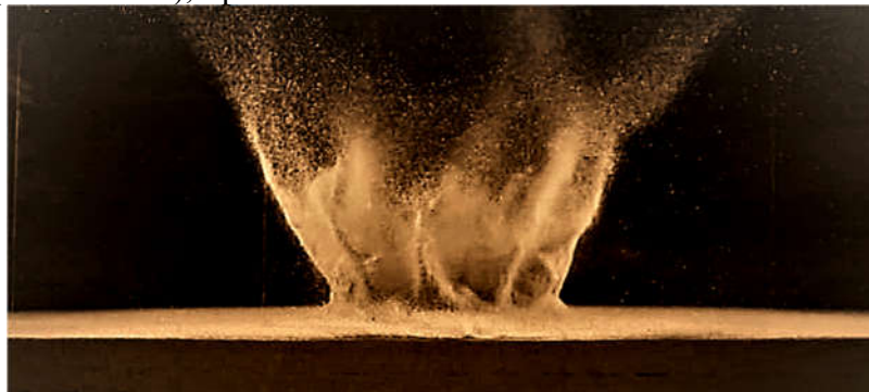
Laboratoryjny krater uderzeniowy w trakcie tworzenia (zdjęcie wykonane w INTA-CSIC).
