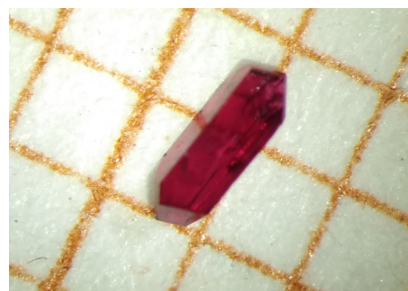
Rysunek 2: Zdjęcie monokryształu [\text{Co}(\text{NCS})_2(4\text{-methoxypyridine})_2]_n .
