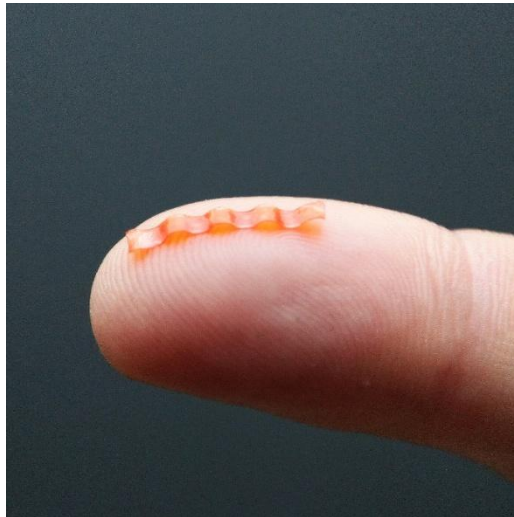
Fig. 1 Naturalnej wielkości robot gąsienica wykonany z ciekłokrystalicznego elastomeru o złożonej orientacji molekularnej może pełzać po oświetleniu wiązką lasera.
