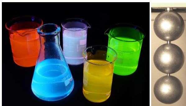
Rysunek 1. Roztwory fluorescencyjne naświetlane promieniowaniem nadfioletowym UV (po lewej) i magnes neodymowy utrzymujący ciężar kul 1300 razy większy od swojego własnego (po prawej).
