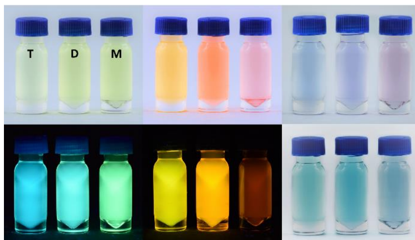
Rysunek 2. Nasze związki zmieniają barwę przy rozpuszczeniu w zależności od polarności rozpuszczalników: toluenie (T), dichlorometanie (D) i metanolu (M).
