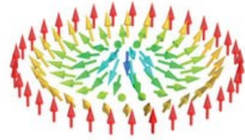
Rys. 1. Dwuwymiarowa wizualizacja konfiguracji magnetycznej przedstawiająca skymion typu Néela. Rysunek został zaczerpnięty z pracy 4 .
