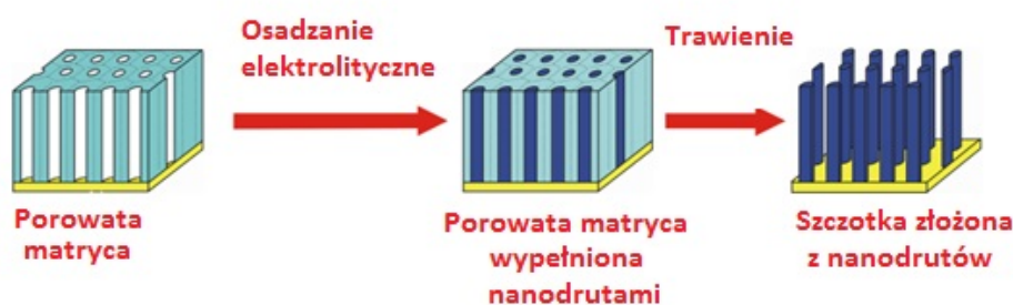
Rysunek 1. Schemat przygotowywania szczotki nanodrutów w procesie osadzania elektrochemicznego w porowatej matrycy.
